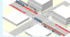
Curbside Lane BRT
