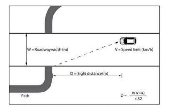
FIGURE 31 - MINIMUM SIGHT DISTANCE FOR MID-BLOCK CROSSING
